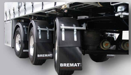
Het drie-assige opleggerchassis voldoet aan de meest recente veiligheids- en kwaliteitseisen en is tevens voorzien van een Europese Typegoedkeuring
