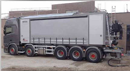
De BreMAT F4.15 wordt op een 4-assig truckchassis en de BreMAT F5.17 op een 5-assig truckchassis geassembleerd.
