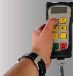
De installatie kan met een radiografische afstandsbediening vanaf de werkplek worden bediend.
