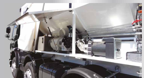
Kosten- en ruimtebesparend: in plaats van een dieselmotor wordt de machine middels een PTO aangedreven, door de dieselmotor van de truck.
